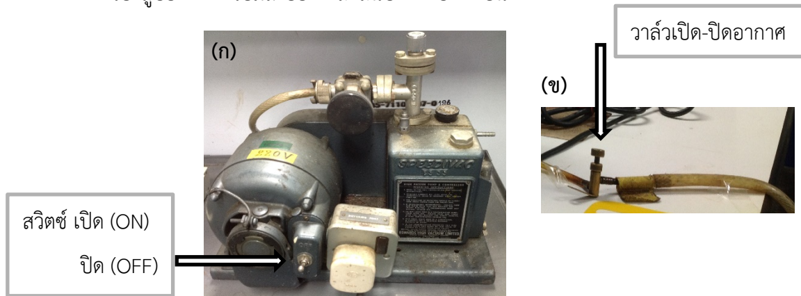
ภาพที่ 6 (ก) เครื่องสูบอากาศพร้อมสายยาง และ (ข) ลื่นปิด - เปิด
