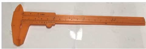
ภาพที่ 6 เวอร์เนียคาลิปเปอร์ ความละเอียด 0.05 มม.
